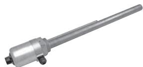
PTHK 91 TH型带温度控制的插入式筒状加热器, 有内部调温和外部调温两种. 标准的可调温度范围 0°C 到 85°C. 保护等级 IP54. 这种加热管的更换, 无需放油. 连接螺纹型号 G 2".
