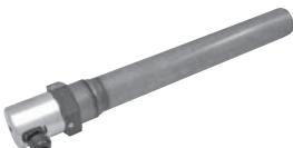
PTHK 90型插入式筒状加热器(筒内带有一个插入式加热棒), 保护等级 IP 65. 这种加热棒更换时, 无需放油. 连接螺纹型号 G 1 1/2" 和 G 2".
